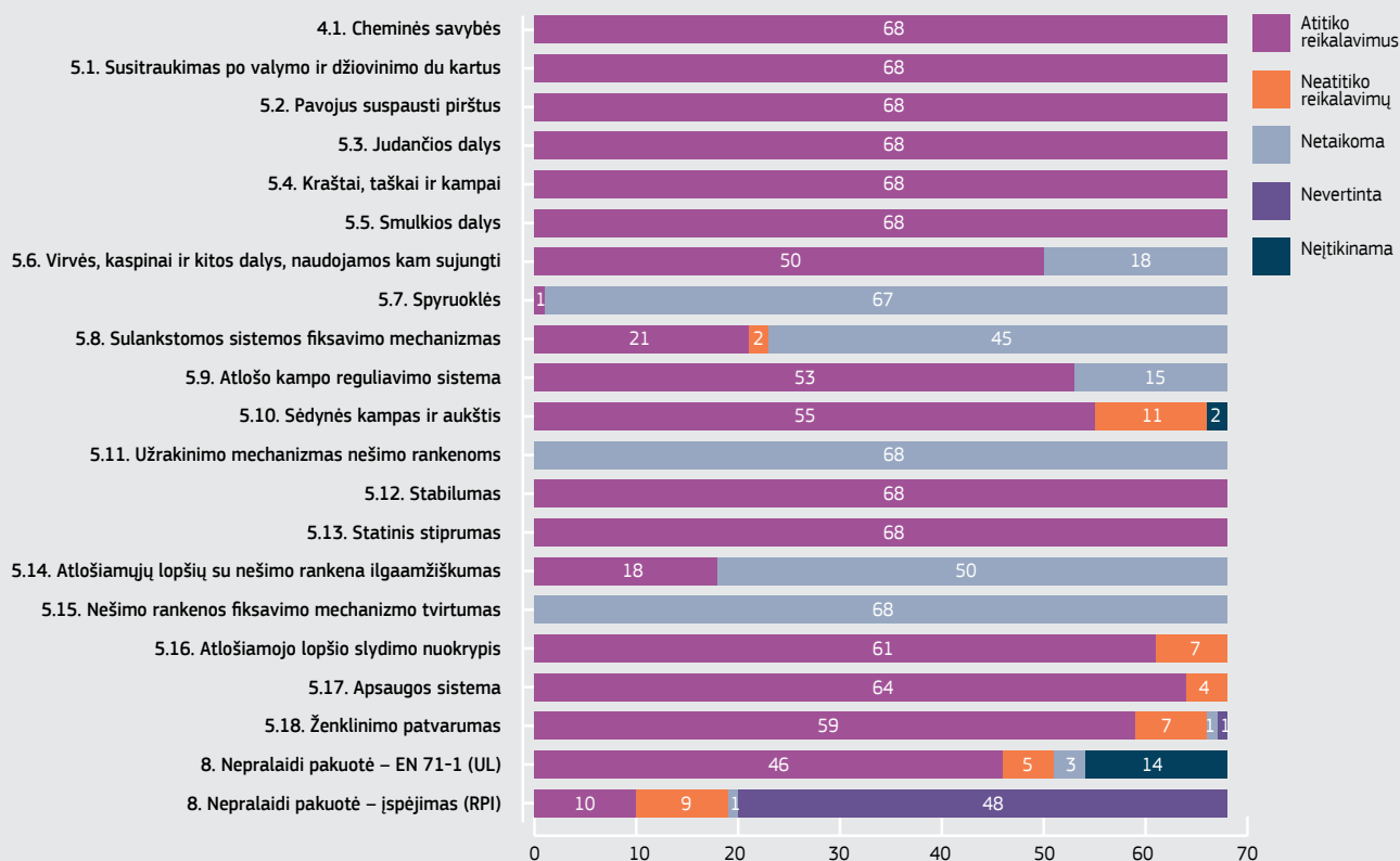
5 paveikslas. Bandymų rezultatai pagal kiekvieną EN 16232:2013 + A1:2018 dėl kūdikių sūpuoklių punktą (N=37)
