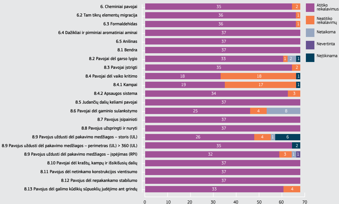
5 paveikslas. Bandymų rezultatai pagal kiekvieną EN 16232:2013 + A1:2018 dėl kūdikių sūpuoklių punktą (N=37)
