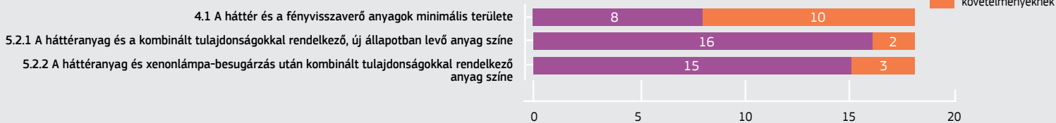
8. ábra – Vizsgálati eredmények pontonként: EN 1150:1999 – Láthatóságot biztosító ruházat
