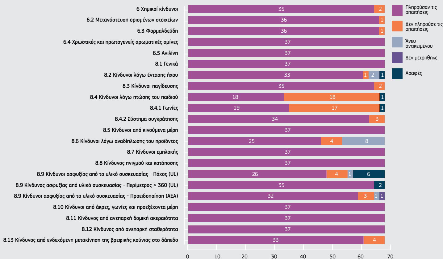
Εικόνα 5 - Αποτελέσματα δοκιμών ανά ρήτρα, EN 16232:2013 + A1:2018 – Κούνιες για μωρά (N=37)
