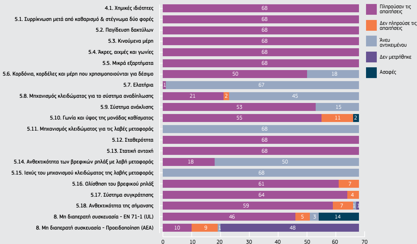
Εικόνα 5 - Αποτελέσματα δοκιμών ανά ρήτρα, EN 16232:2013 + A1:2018 – Κούνιες για μωρά (N=37)
